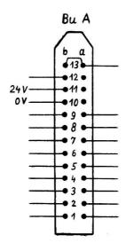
Die Kontaktbelegung stimmt mit dem Fernsteueranschluß der Mehrspuranlage überein.
