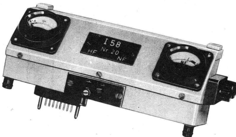
Die J 58 dient zur Messung der beim Magnettonaufsprechvorgang benötigten Ströme im R 9 bzw. R 9c, sowie des Frequenzganges des Aufsprechstromes. Außerdem wird der Frequenzgang des Magnettonwiedergabeverstärkers mittels der eingebauten Hörkopfersatzschaltung gemessen. Zur Anzeige sind zwei Instrumente vorhanden, von denen das eine von NF auf Vormagnetisierung umschaltbar ist.
