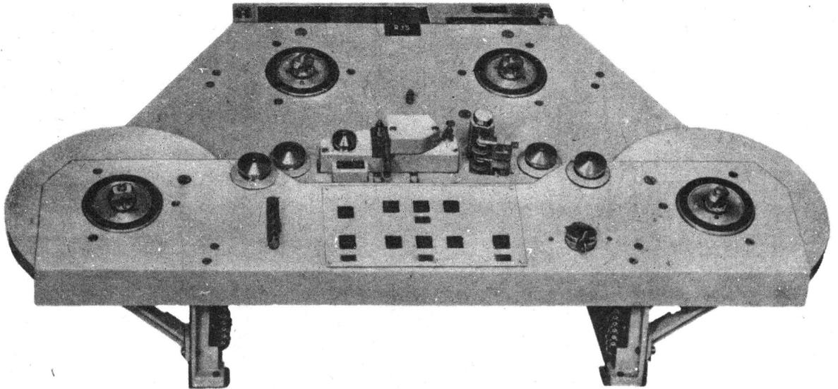
Das R 35 dient vorzugsweise zum intermittierenden Umschneiden von Magnettonbandaufnahmen von einem Urband auf ein Kopieband (beide 6,25 mm breit) mit 76,2 cm/s Bandgeschwindigkeit. Zusammenfassung von zwei Laufwerken mit je einem Ab- und einem Aufwickelmotor sowie einem gemeinsamen Tonmotor und Kopfträger.
