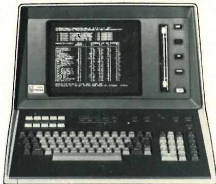
**Rechnergesteuert:** Programme in BASIC für Steuerung, Meßwertverarbeitung und Protokollausgabe auf einer Kassette. Datenausgabe über Sichtgerät, Hard-copy oder Schnelldrucker.
