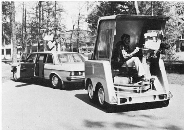
Die Höchstgeschwindigkeit dieser „Elektronischen Außenproduktionswagen“ liegt – vollbeladen – bei 160 Stundenkilometern, jedoch ohne Anhänger. Jede Fahrereinheit ist mit zwei Farbkameras und den dazugehörigen Basisstationen ausgerüstet. Bildkontrolle, Aufzeichnungsanlage, Tonmischeinrichtung und HF-Übertragungsstrecke sind im Personenwagen eingebaut.
