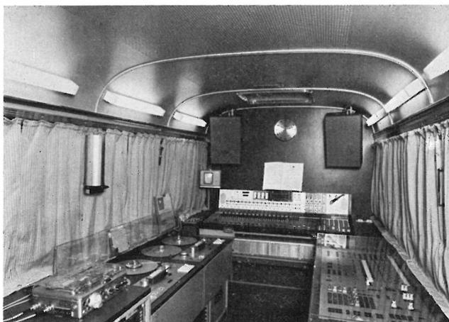
Dach und Seitenwände sind wärme- und schallisoliert; ein Sonnenschutzdach vermindert die Wärmeeinstrahlung. Zur Standheizung dient ein dieselbetriebenes Warmwassergerät mit drei stufenlos regulierbaren Wärmetauschergebläsen.
