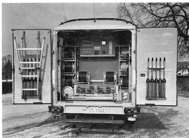
Entsprechend den Möglichkeiten der Regieeinrichtung wird ein sehr umfangreiches Übertragungszubehör mitgeführt (etwa 200 kg), das in zahlreichen Staufächern und Schubladen untergebracht ist.
