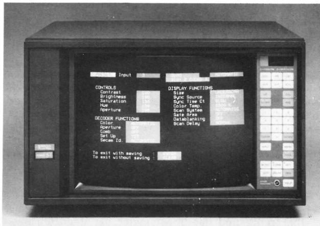
Eine weitere Aufgabe des Mikroprozessors ist die Steuerung des Festbildgenerators für Weißfeld, Farbbalken und Gitter. Mit diesem Generator kann eine erste Analyse des Bildes und der Konvergenz ohne externe Hilfsmittel durchgeführt werden. Da für die Steuerung des Monitors digitale Signale verwendet werden, ist die Fernbedienung eines Gerätes oder ganzer Monitorwände durch eine Fernbedieneinheit möglich.
