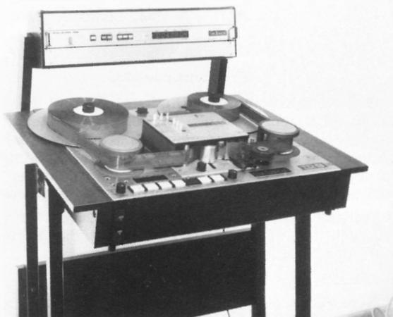
Unser Bild zeigt das STELLAVOX-Magnetbandgerät TD-9P 35 in der Ausbaustufe für 35-mm-Perfo-Magnetband als 3-Spur-Ausführung mit Koppelsystem STELLALOCK ASB. TD-9 und ASB sind für Studiobetrieb in dem Fahr- und Schwenkgestell ANF montiert. Bauform und Anordnung erlauben sitzende Bedienung in ergonomisch richtiger und ermüdungsfreier Haltung. Da das Gerät auch in senkrechter Betriebslage arbeitet, ist Gestellmontage möglich.
