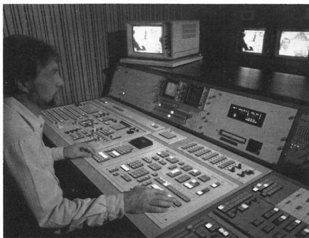
Mischpult mit einem VCA-Pegelsteller für jeden Eingangskanal ausgeführt.
